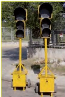
Juego de 2 semáforos portátiles sincronizados, plegables, cabezal de focos leds, tricolor (verde, ámbar y rojo) con lentes de 200 mm diámetro programador electrónico, autonomía 7 días aproximadamente con una batería de 12 V y 130 Ah.
