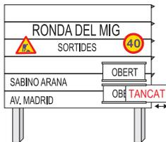
Señales con parte desmontable a base de chapas de aluminio que se colocan con varias leyendas.
