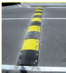
Fabricadas en goma, en piezas de color negro o amarillo. La banda reductora modelo MAURO está diseñada para la reducción de los excesos de velocidad a la que habitualmente circulan los vehículos en carreteras locales. Cambiar la altura longitudinal en el perfil de la carretera obliga a los conductores a reducir la velocidad de sus vehículos. La pieza se fija al aglomerado mediante 4 tacos expansivos.
