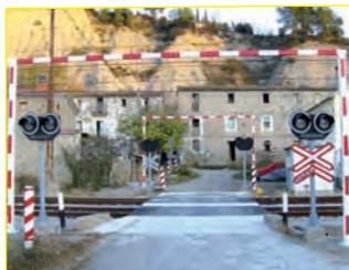
Fabricado en perfiles de hierro de 120 x 60 x 3 cm placa móvil de aluminio de 200 mm de ancho, alturas hasta 3.500 mm, anchuras del pórtico hasta 5 m pintado rojo y blanco reflexivo.
